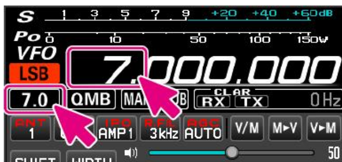
Rys. 11.1. U dołu widocznego wycinka znajduje się regulator siły głosu
